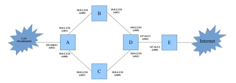
**Partie** A – On souhaite faire en sorte que le traffic qui va du LAN vers Internet passe par le routeur B et celui qui va d'Internet au LAN passe par le routeur C.
